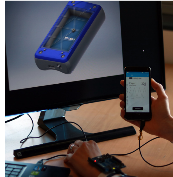
Figuur 10. Universeel wearable sensorbord voor om een pols dat data verstuurd via bluetooth naar een app op een smartphone vanwaar het doorgestuurd wordt naar de cloud. Dit is een mooi voorbeeld van de complexiteit van hedendaagse producten waar soft- en hardware geïntegreerd wordt tot één product. © Copyright SJJ Pieters 2016, gedrukt met toestemming.
