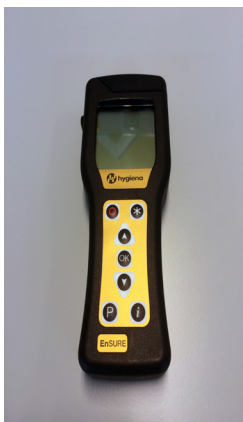
Figuur 6. Draagbare ATP Hygiëne monitoring device van Gullimex voor het vaststellen van biologische contaminatie © J.M. Tuijthof 2016, herdrukt met toestemming.
