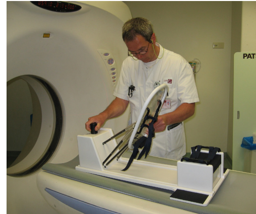
Figuur 11. Foto van een prototype van een voetplaat waarmee de voet van een patiënt in de CT-scan in verschillende extreme standen kan worden gepositioneerd. Een CT-laborant bedient de voetplaat die op de CT-scanner band ligt. © GJM Tuijthof 2010, gedrukt met toestemming.
